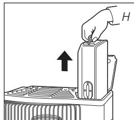
**2** Soulevez le couvercle ⑧, dégarez le réservoir amovible ⑨ et retirez-le de l'appareil (fig. H). Attention! quelques gouttes de combustible peuvent encore s'écouler du réservoir. Posez le réservoir amovible (bouchon en haut, poignée au sol) puis dévissez le bouchon du réservoir, à l'aide du bouchon "ouverture main propre" (fig. I).
