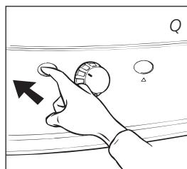
Dit apparaat is uitgerust met een veiligheidssysteem dat de kachel uitschakelt wanneer de wisseltank uit de kachel genomen wordt (fig. P). Om de kachel opnieuw te ontsteken dient u het reservoir terug te plaatsen in de kachel en de instructies te volgen zoals aangegeven in hoofdstuk C.
