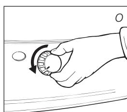
**!** Efter ovnen er tændt, skal det altid kontrolleres, at forbrændingskammeret **4** står rigtigt, ved at skubbe det fra venstre til højre (fig. E) vha. håndtaget **5**.
