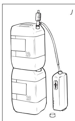
**4** Serrez le bouton situé au dessus de la pompe (en le tournant à droite).
