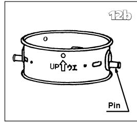
**13** Platzieren Sie den Dochthalter ( mit Docht ) wieder an der ersten Luftöffnung. Anschließend drehen Sie den Dochthalter im Uhrzeigersinn auf die Dochtbefestigung.
