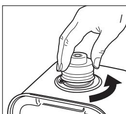
**3** Tome la bomba manual de combustible e introduzca el tubo liso, más rígido en el bidón, procurando que éste último esté colocado más alto que el depósito extraíble (fig. J). Introduzca la goma flexible ranurada en el orificio del depósito extraíble.
