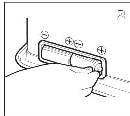
**2** Nehmen Sie die Batterien aus dem Batteriefach **②**.
