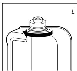
**8** Vérifiez que le bouchon du réservoir est bien vissé. Remettez le réservoir amovible dans l'appareil (bouchon en bas). Refermez le couvercle. Pensez à fermer votre bidon pour éviter des dépôts d'eau. Assurez-vous de bien serrer le couvercle du réservoir de carburant et confirmez qu'il n'y a pas de fuite lorsque le côté du couvercle est placé vers le bas. Ensuite, insérez le réservoir de carburant amovible dans le chauffage.
