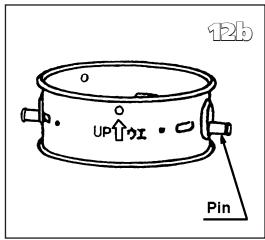
**13** Remettez l'ensemble (anneau de mèche et mèche) dans son logement. Tournez-le dans le sens des aiguilles d'une montre afin de bien le repositionner.
