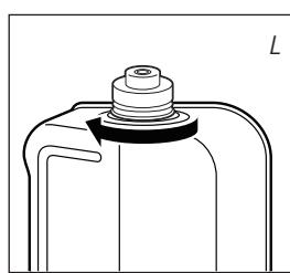
**8** Controllare che il tappo del serbatoio sia diritto e ben avvitato. Porre nuovamente il serbatoio estraibile nella stufa (con il tappo verso il basso). Chiudere il coperchio. Accertarsi di serrare il tappo del serbatoio del carburante e verificare che non vi siano perdite di carburante dal tappo, dopo che è stato installato. Inserire quindi il serbatoio del carburante asportabile nel riscaldatore.
