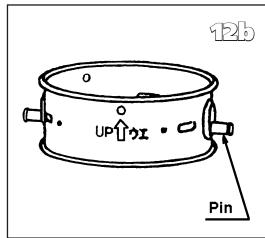
**13** Instale el soporte de mecha (con la mecha dentro) en el tubo de aire primario. Entonces, gire el soporte de mecha en el sentido a las agujas del reloj y ajuste los pivotes del mismo en los encajes del mecanismo de la mecha hasta que quede bien sujetado.
