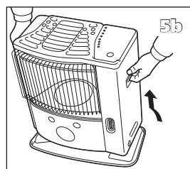
**5** Die drei Gehäuseschrauben an der Unterseite lösen. Das Gehäuse ein wenig nach vorn ziehen und von der Bodenplatte abnehmen.
