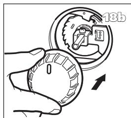
**19** Sæt den fyldte skiftetank tilbage. Sæt batterierne i batteriholderen (bemerk plus og minus). Når skiftetanken og batterierne er anbragt, skal du vente 30 minutter, før du tænder for kaminen.
