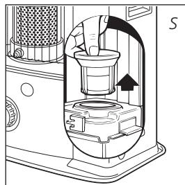
**2** Nehmen Sie den Brennstoftank **9** aus dem Kaminofen und entfernen Sie den Brennstofffilter (Abb. S). Dieser kann eventuell etwas nachtropfen; halten Sie ein Tuch bereit. Den Brennstofffilter und den Brennstoftank außerhalb des Kaminofens aufbewahren.
