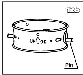
**13** Inserire l'anello porta stoppino (completo di stoppino) nel cammino d'aspirazione. Girare l'anello porta stoppino in senso orario per fissarlo alla manopola.
