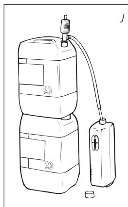
**4** Fissare la manopola che si trova sopra la pompa (verso destra).
