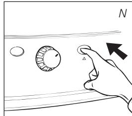
Haben Sie das Heizgerät gestartet und es schaltet sich kurz danach wieder aus, müssen die Batterien ausgetauscht werden. Am besten verwenden Sie dazu neue Alkaline-Batterien (2 x Größe D).
