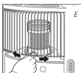
**!** Si ha sacado la parte izquierda de la rejilla, inserte primero el pivote de la parte superior izquierda en la ranura, y luego inserte el pivote inferior izquierdo en su ranura (fig. F).
