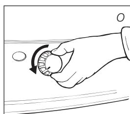
! Vor dem Starten des Kaminofens immer kontrollieren, ob die Brennkammer ④ gerade steht, indem Sie den Handgriff ⑤ kurz nach links und rechts schieben (Abb. E). Dies muß ohne Schwierigkeiten möglich sein. Wenn die Brennkammer schräg steht, führt dies zu Rauch- und Rußentwicklung.
