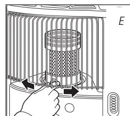
**!** Antes de encender la estufa, controle siempre si la cámara de combustión **4** está bien recta, moviéndola con ayuda del asa **5** un poco a la izquierda y derecha (fig. E). Esto se efectuará sin ninguna dificultad. Si la cámara de combustión está desnivelada, se producirían humos y hollín.
