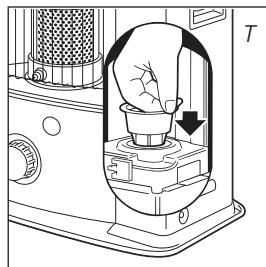
**3** Setzen Sie den Transportverschluß anstelle des Brennstofffilters ein (Abb. T) und drücken Sie ihn fest, so daß kein Brennstoff austritt.
