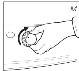
Si al encender la estufa, éste se apaga casi de inmediato, deberá sustituir las pilas. Se recomienda usar pilas alcalinas nuevas (2 unidades, tamaño D).
