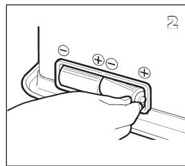
**2** Retirez les piles qui se trouvent dans leur logement à l'arrière de l'appareil **12**.
