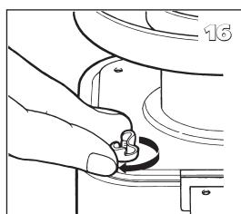
**17** Inserire di nuovo la manopola nella sua sede. Ruotare la manopola completamente verso destra. Premere il tasto di spegnimento. Controllare che lo stoppino si abbassi del tutto. Ripetere più volte questo controllo. Se lo stoppino non si abbassa completamente, non è stato montato bene nel suo meccanismo. In questo caso la procedura deve essere ripetuta a partire dal n° 12. Sfilare la manopola dalla stufa.
