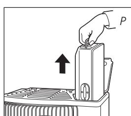
**!** Questa stufa è equipaggiate con un sistema di sicurezza che spegne la stufa dal momento che il serbatoio viene estratto (fig. P). Per accendere la stufa rimettere il serbatoio al suo posto e seguire l'istruzioni in capitolo C.
