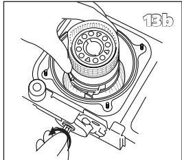
**14** Remettre la butée de maintien. Visser la vis qui tient la butée de maintien.
