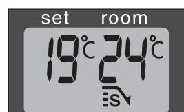
I: Als het lampje SAVE oplicht, slaat de kachel automatisch aan en uit, om binnen een bepaald temperatuurbereik te blijven.
