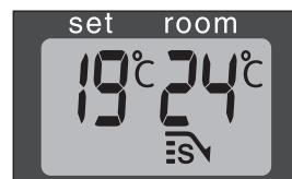
I: Når sparelampen tennes, slår varmeovnen seg på eller av automatisk for at temperaturen skal holde seg innenfor et bestemt område.
