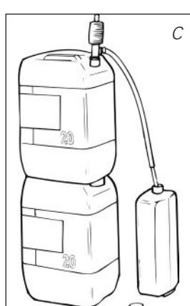
**4** Durante il rifornimento, fare attenzione all'indicatore del combustibile nel serbatoio estraibile (fig. D). Se questo è pieno, interrompere il rifornimento. Non riempire mai troppo il serbatoio, soprattutto se il combustibile è molto freddo (il combustibile fuoriesce se diventa caldo).
